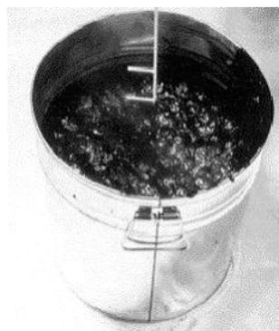
写真-1 フォームドアスファルトの外観
