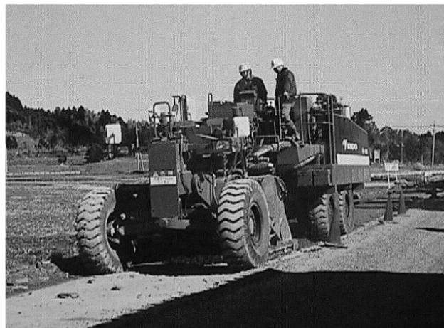
写真-3 路上破碎混合機(単独施工タイプ)
